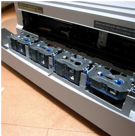
Billedet viser ALPS printeren med åben låge og synlige farvebånd.
